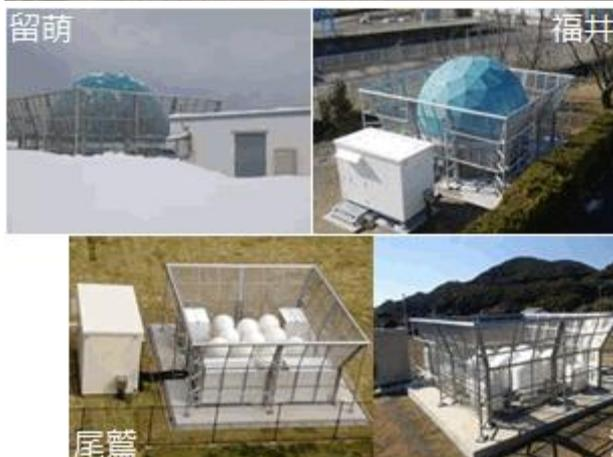
ウィンドプロファイラ観測局の外観の例(上段は高松観測局、中段は左が留萌観測局、右が福井観測局、下段は左が尾鷲観測局、右が清水観測局)。冬季に積雪の影響を受ける観測局では、測器全体をドームで覆っている。
