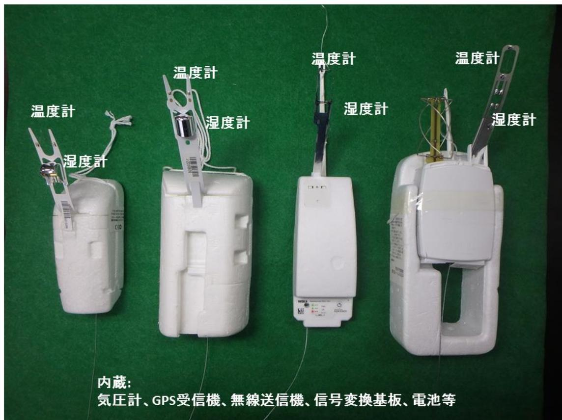
気象庁で使用しているラジオゾンデ(左から iMS-100、RS-11G、RS-41SG、RS92-SGP)の外観
